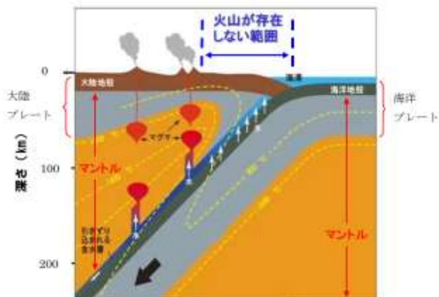
図3 沈み込み帯におけるマグマ発生モデルの例（巽、1995 を編集）
