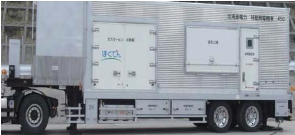
写真3-3 安全設備対策の実例（高台に配置されたガスタービン発電車）
